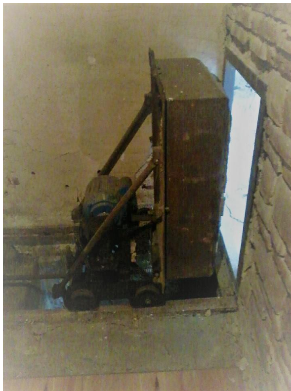
Imagen n° 7 y 8: Mecanismo eléctrico o manual que se desplaza sobre rieles para ingresar a la imprenta. Fotografía tomada por la autora en el marco de una de las visitas guiadas realizadas a la Casa Mariani-Teruggi el 11 de julio de 2015.
